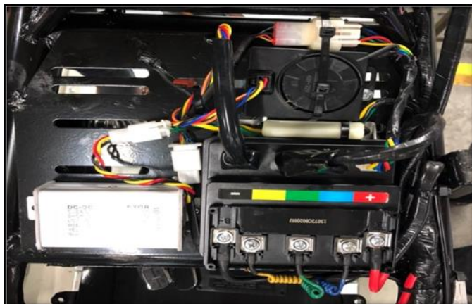
รูปที่ 4.2.4. แสดงผลติดตั้งชุดคอดไทลเลอร์
