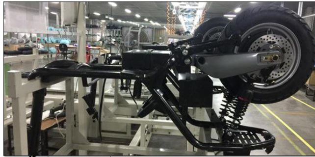
รูปที่ 4.3.1. แสดงผลการติดตั้ง Hub Motor
